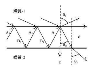
"**透過光**"は、膜をすんなり通過する光の他に、一旦膜内部に入って多重反射した上で m/2 界面から出てくる光が付け加わる。2/m 界面での境界条件にはこの多重反射光を加えたものに対して適用する。 点  $(h_m \tan \theta_m, h_m)$  における透過光に含まれる多重反射光の属性は、下の通りである。
