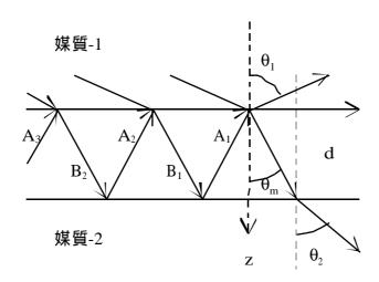
"**反射光**"は、1/m 界面で反射した光のほかに、一旦膜内部に入って多重反射してから m/1 界面から出てくる上向き (-) 光が付け加わる。1/m 界面での境界条件には、この多重反射光を(膜の両側で)加えたものに適用する。
