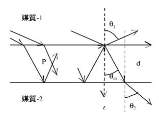
原点で反射される光に寄与する多重反射光がたどる膜内部の光路(下図で、 $d=h_m$ である)
