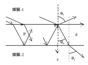
原点で反射される光に寄与する加重反射光がたどる膜内部の光路(下図で、 $d=h_m$ である)
